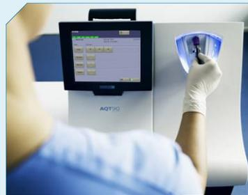
**1) Поместите закрытую вакуумную пробирку с пробой в анализатор**
