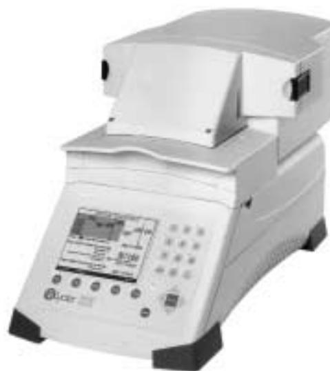
Рис. 3. Прибор для ПЦР в реальном времени. На рисунке представлен Ай-Сайклер АйКью производства «Био-Рад Лаборатории» (США)
